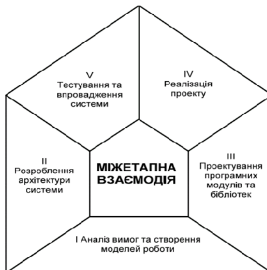
Рис. 2. Етапи проектування системи візуалізації
