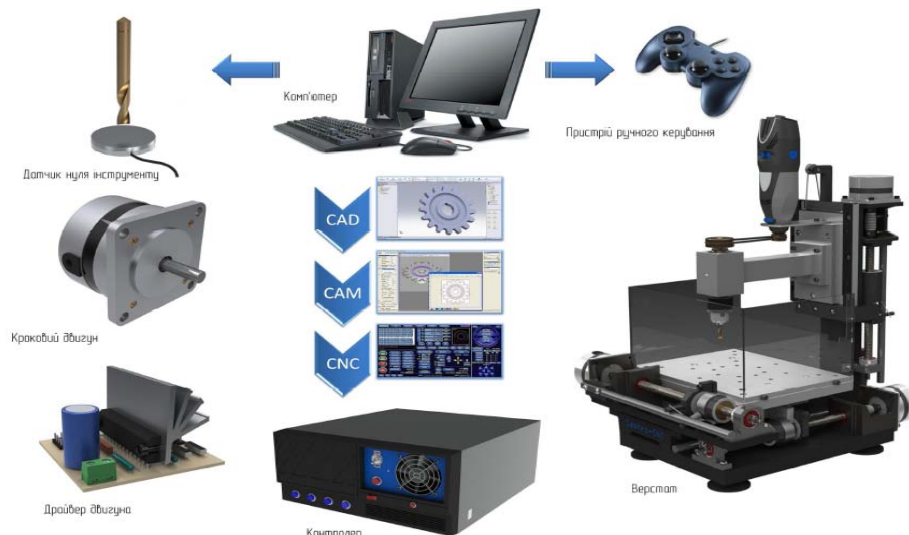
Рис. 1.1. Етапи підготовки процесу обробки деталі на верстаті з ЧПУ
