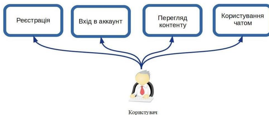
Рисунок 2 – Діаграма варіантів використання для користувача
